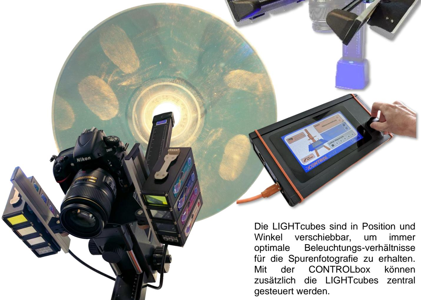
Die LIGHTcubes sind in Position und Winkel verschiebbar, um immer optimale Beleuchtungs-verhältnisse für die Spurenfotografie zu erhalten. Mit der CONTROLbox können zusätzlich die LIGHTcubes zentral gesteuert werden.
